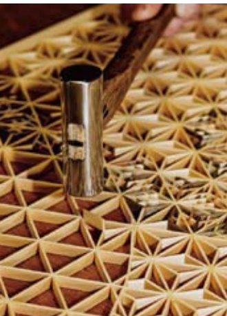
金槌で圧をかけて組み込み、釘を用いずに木を組み付け、強固な接合にする。
