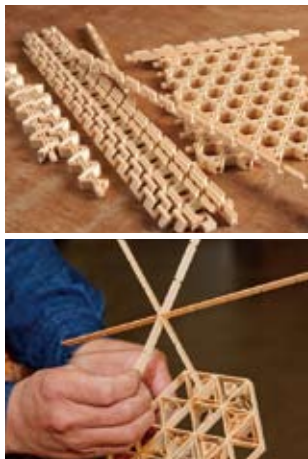
作る紋様に応じて溝(切れ込み)や角度、長さなどを計算して切り、一つ一つを組み込んでいく。
